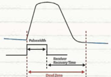
**Attenuation Dead Zone(ADZ)**은 옆의 그림과 같이 Connector Pair에서 반사된 빛이 데드존을 형성하여 바로 뒤의 Fusion Splice의 감쇄 부분을 덮어 OTDR에서 확인이 불가능한 경우이며, 이러한 경우에는 이벤트 측정이 불가능하게 됩니다.
