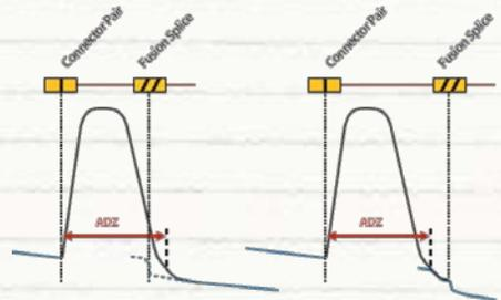
**Event Dead Zone(EDZ)**은 그림에과 같이 연속되는 Connector Pair에서 반사된 빛이 각각의 데드존을 형성하며, 이 빛들이 중첩되면서 더 큰파장을 생성하게 됩니다. 이러한 경우에 이벤트에 관한 확인이 어렵습니다. 그러나 두 Connector Pair의 사이가 조금 더 떨어져 있어서 오른쪽 그림과 같이 파장이 구분 되면 데드존이 발생 하여도 이벤트 구분이 가능 합니다.
